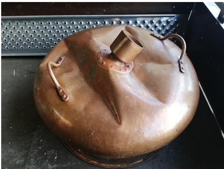
Chapiteau déformé par le choc contre les poutrelles du plafond.
